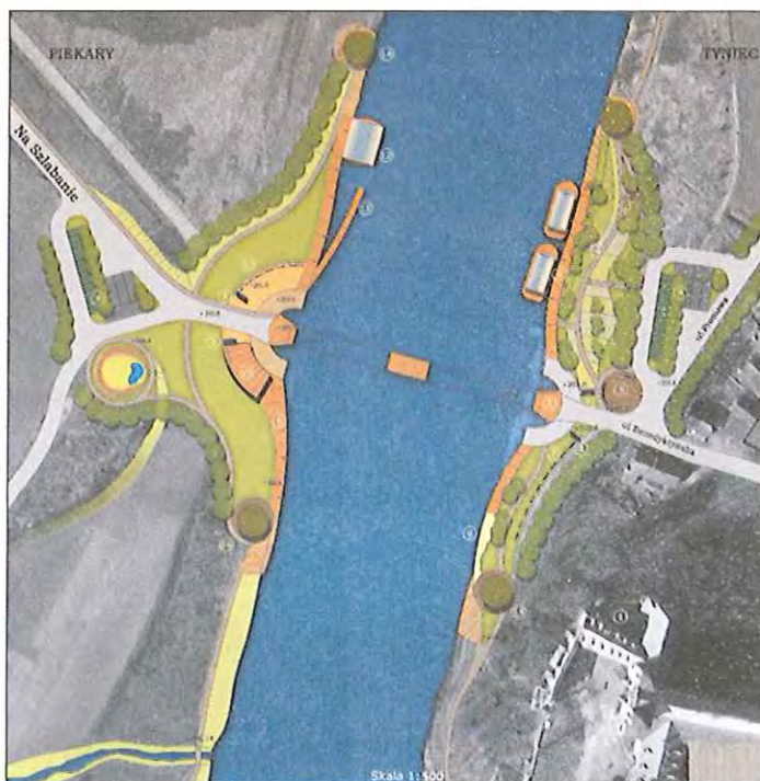
Ryc. 4. Projekt promu i zagospodarowania przyczółków. Fig. 4. Ferry design and abutment arrangement.
